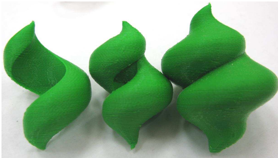
Рис. 1: Фотография трёх множеств достижимости «в момент» для машины Дубинса, напечатанных на 3D-принтере
