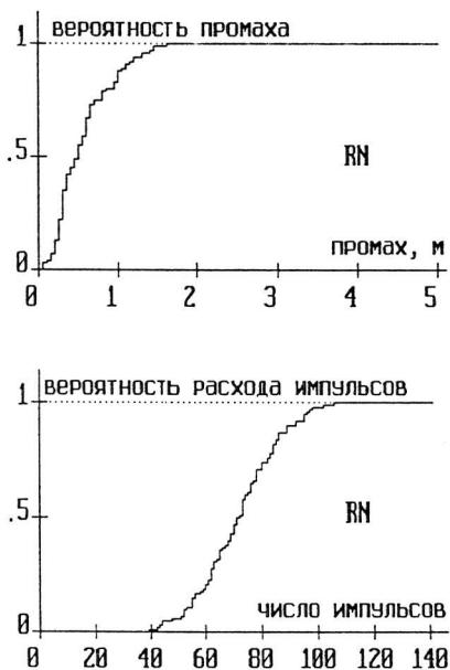
Рис. 17. Способ управления SM в пространственной задаче преследования. Законы распределения вероятностей промаха и числа истраченных импульсов; вариант случайной помехи.
